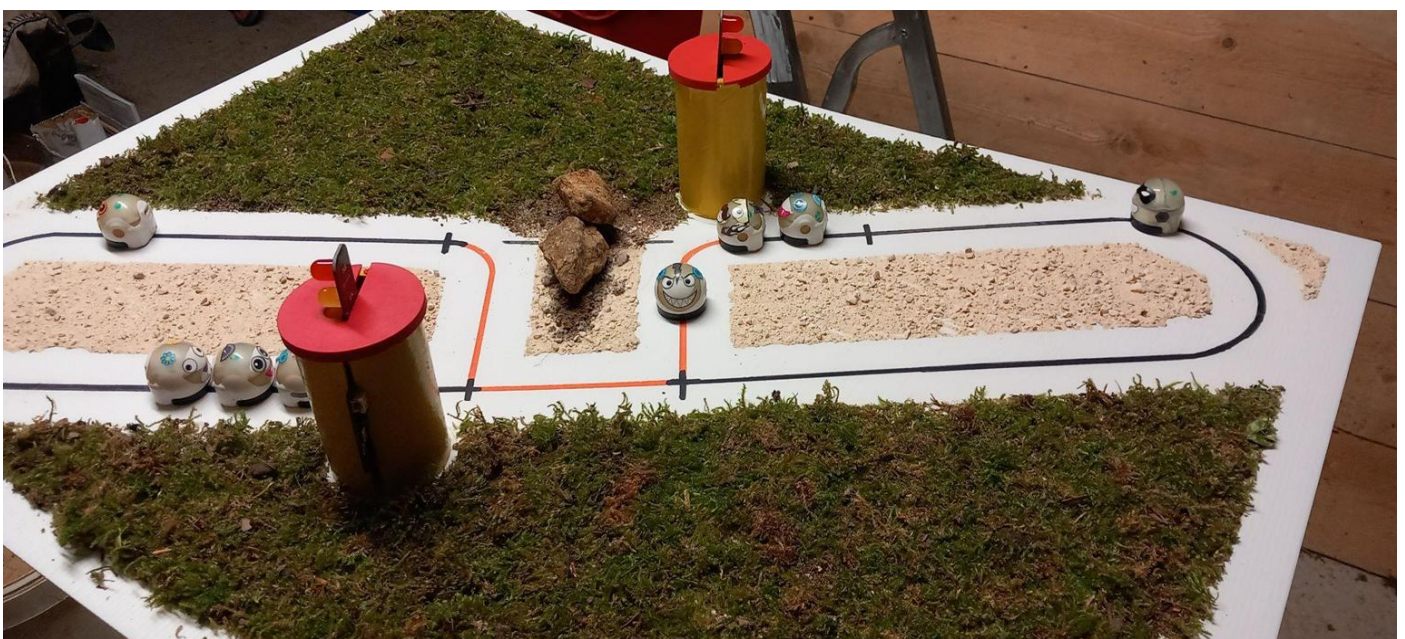
Figure 10 : Plateau d'expérimentations et de mesures des temps de trajets des véhicules
