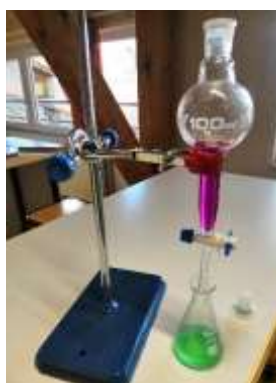
Récupération de la phase aqueuse contenant le sulfate de cuivre
